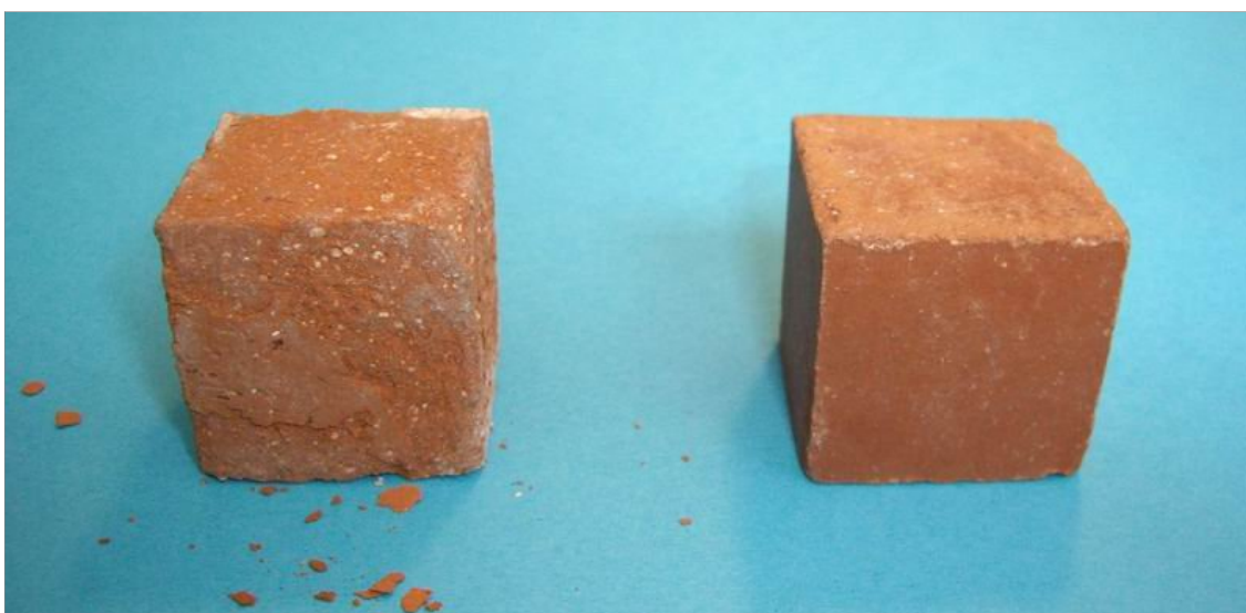
Лабораторијски модели цигле након 30 циклуса смрзавање-одмрзавање: еталон и конзервиран узорак
