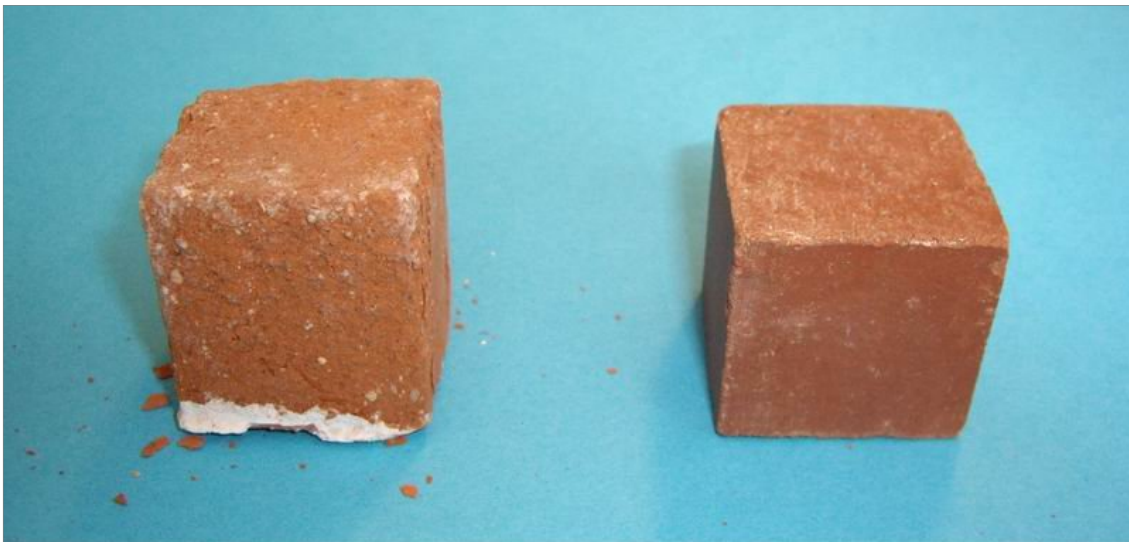
Лабораторијски модели цигле након 6-месечног излагања влаги: еталон и конзервиран узорак
