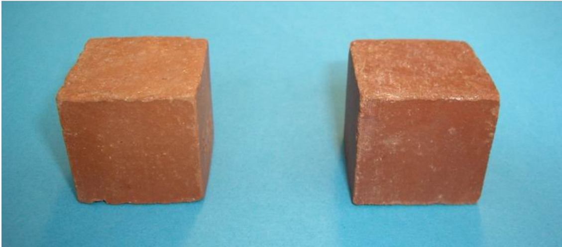
Лабораторијски модели цигле: еталон и конзервиран узорак
