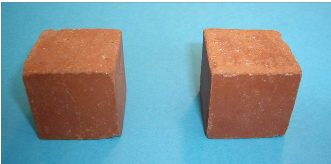
Лабораторијски модели цигле: еталон и конзервиран узорак
